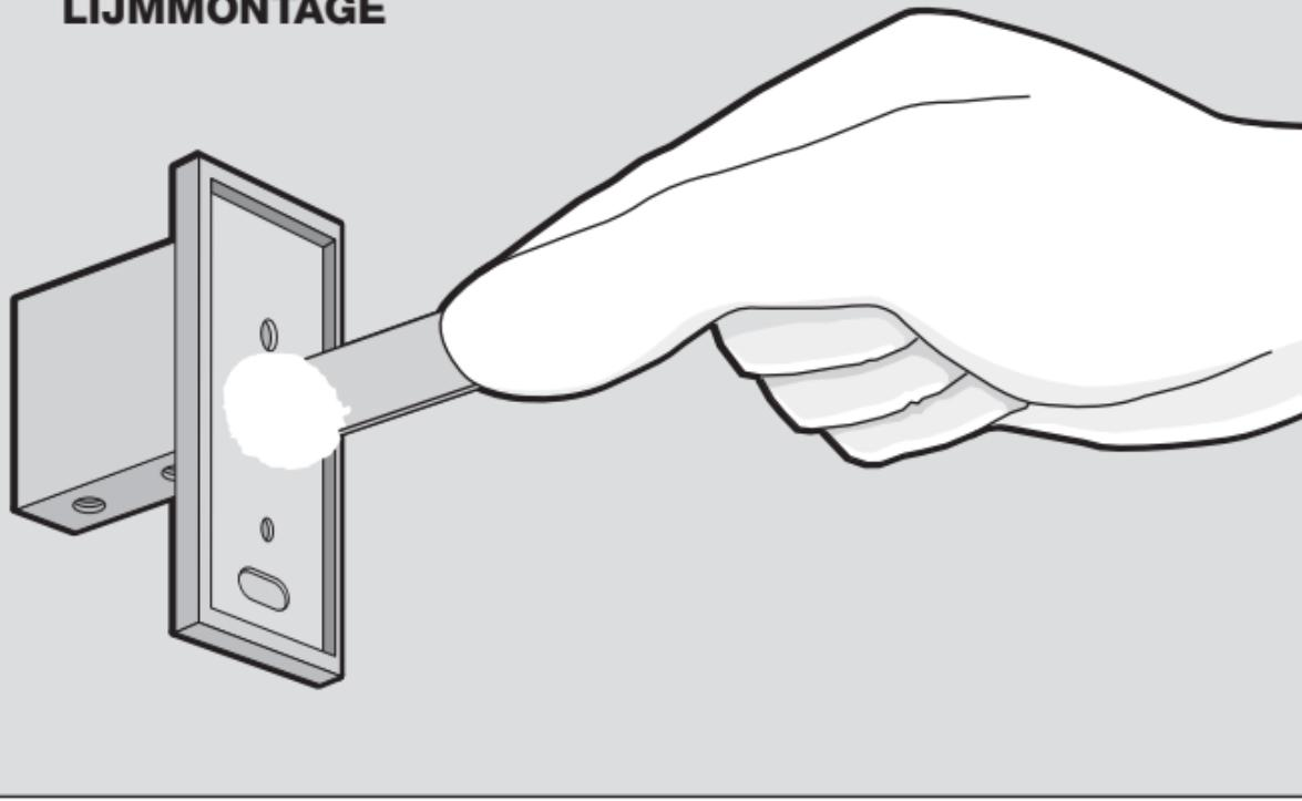
**D:** Angemischtes ZackMount-Haftmittel mit dem Spatel mittig auf die Montageplatte auftragen. Für die Verarbeitung des Klebers (nicht im Lieferumfang enthalten) beachten Sie bitte die dem Kleber beiliegende Bedienungsanleitung.
