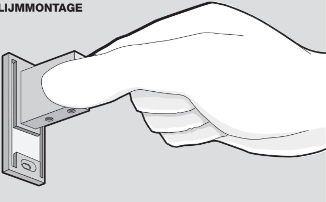
**D:** Wandhalter an die Wand andrücken. ZackMount kann je nach Witterung ca. 15 Minuten verarbeitet und korrigiert werden. Eventuell ausgetretenen Kleber am besten erst nach Aushärtung mit einem Cuttermesser entfernen, oder mit dem Finger abrubbeln.
